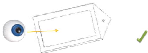
**Frente despejado:** El frente debe estar lo mas despejado posible para acceder a una rápida inspección visual del interior de la luminaria.
