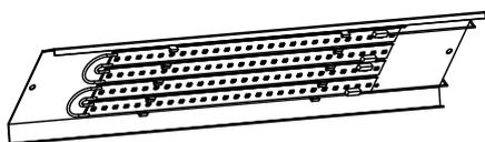
**Mantenimiento:** Los mantenimientos deben realizarse sin desmontar la base de las luminarias, en los casos de iluminantes con placas y driver, los mismos deben estar montados sobre una bandeja intercambiable, para facilitar la operación.
