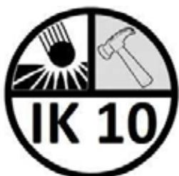
**Robustez:** Se determina por el grado de protección proporcionado por los envolventes de materiales eléctricos contra impactos mecánicos externos. Norma IEC 62262 2002-21.
